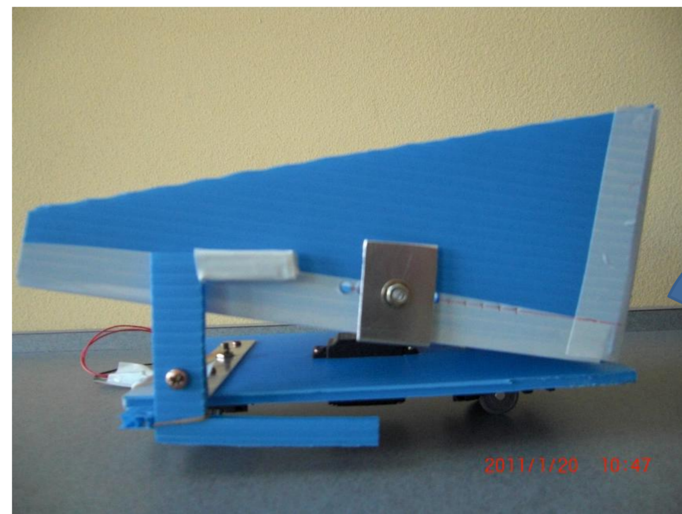
籠が横を向き、リンクの働きにより籠が前に傾くのでピンポン球を排出できる
